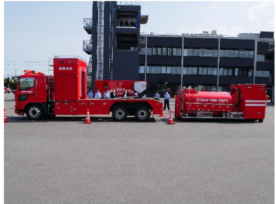
消防支援車(左)と消火用タンクコンテナ
